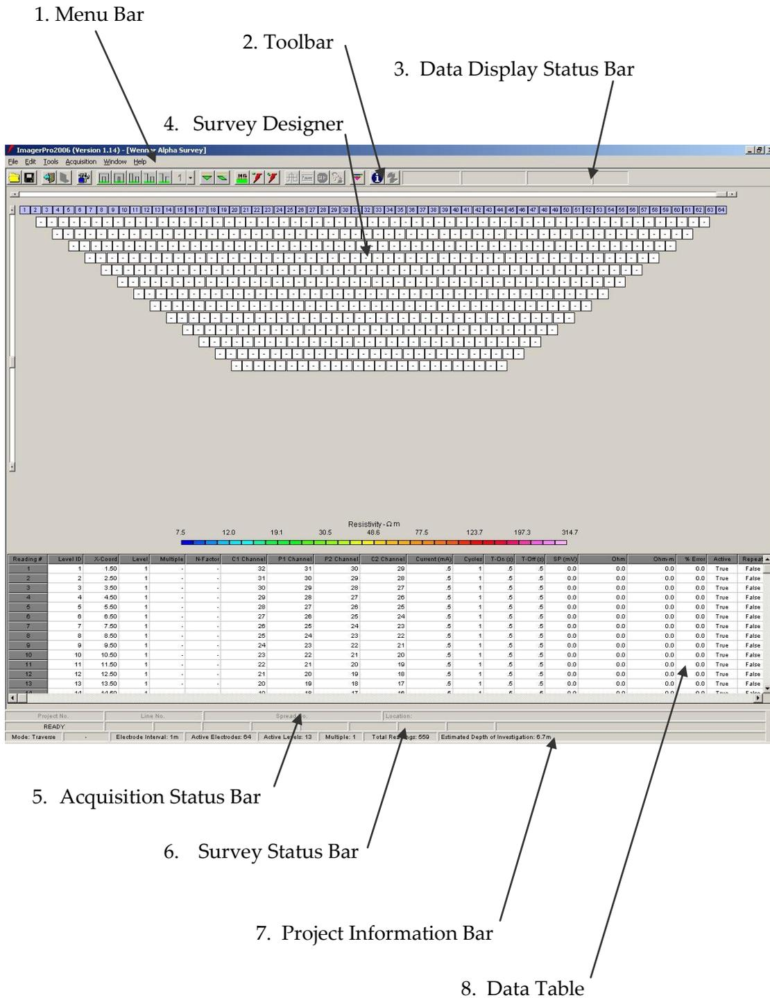
Figure 1: The ImagerPro2006 Survey Window
